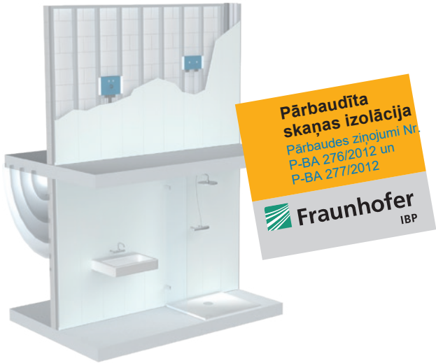
Uponor Smart ISI kaste tiek ievietota horizontāli starp iepriekš uzstādītiem sausās būves profiliem.
