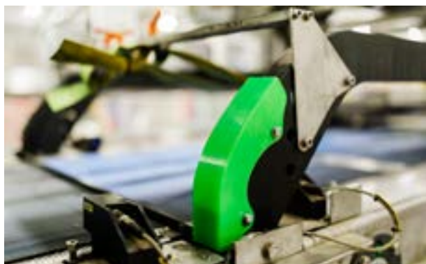
Les pièces de rechange fonctionnelles qui sont imprimées en 3D peuvent être créées sans avoir besoin de tenir un stock
