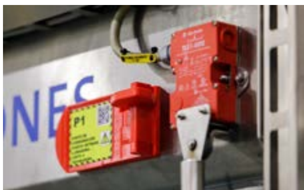
Loquet de sécurité imprimé en 3D ayant pour rôle d'empêcher tout démarrage des machines durant la maintenance
