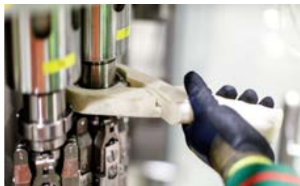
Les outils imprimés en 3D facilitent et accélèrent la maintenance
