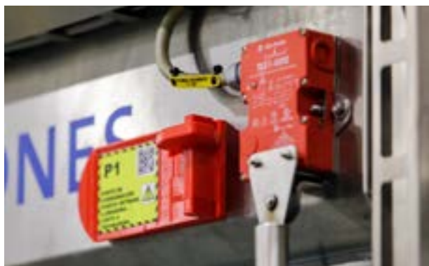
3D-geprint veiligheidsslot verhindert dat machines starten tijdens het onderhoud
