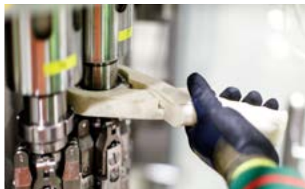
3D-geprinte tools maken het onderhoud eenvoudiger en minder tijdrovend
