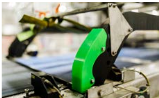
3D-geprinte functionele vervangende onderdelen kunnen gemaakt worden zonder voorraad
