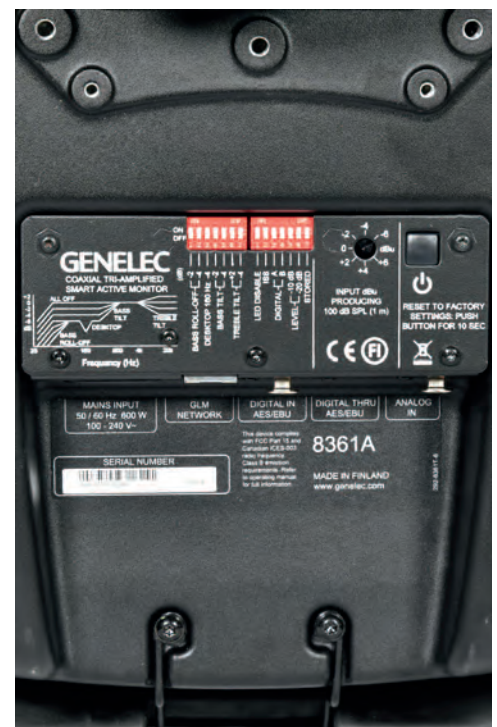
Das Anschlussfeld auf der Rückseite einer Genelec 8361A, wo die typischen Einstellungen zur manuellen Ortsanpassung gemacht werden können.
